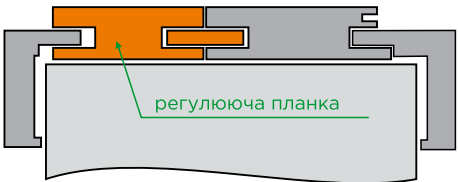
Переріз дверної коробки із регулюючою планкою та шпонкою
